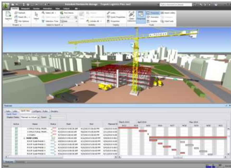
شکل ۵: ادغام مدل‌های BIM و مدل‌های مدیریت پروژه‌ای و تولید مدل ۴D
